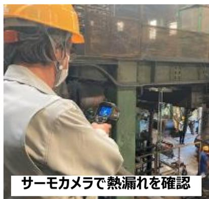
サーモカメラで熱漏れを確認
