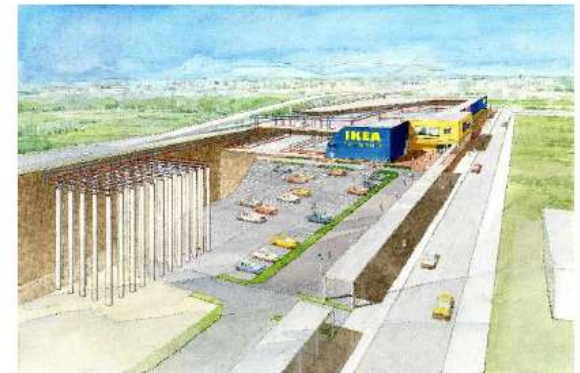
駐車場に深さ100mの地中熱交換器を70本掘削した。
