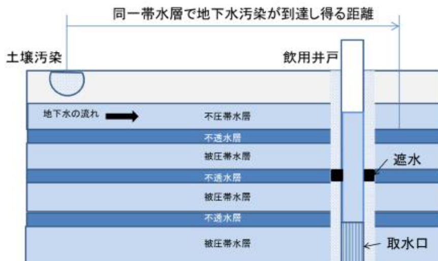
図—1 土壤汚染の発生場所と飲用井戸の関係イメージ図
