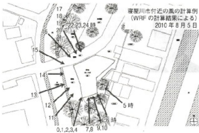
図-15 風の時間変化図：建物の通風換気のための開口位置検討への応用例
