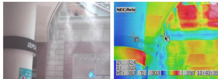
▲サーモカメラで見ると、ミストが出ている部分は温度が低くなっているのがわかります。
