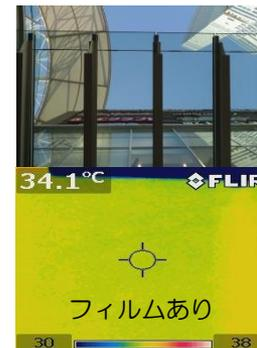
▲サーモカメラで見ると、遮熱性フィルムを貼り付けたひさし自体も温度が低くなっているのがわかります。
