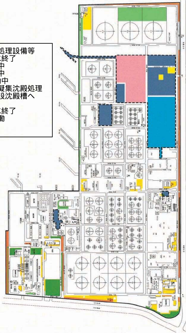
図-1. 仮設凝集沈殿処理設備等の設置場所（工事中）
