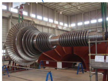
蒸気タービン
