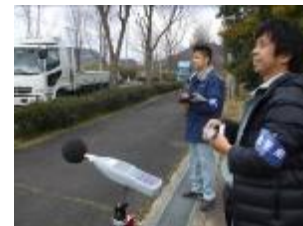
道路交通騒音の測定
