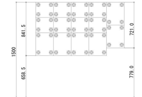
添付図 10 各部詳細図 (点字表示板)
