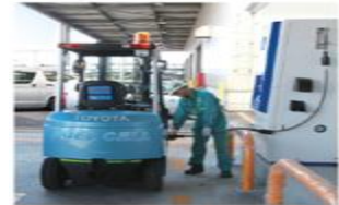
燃料電池フォークリフトの実証運用（関西国際空港）
