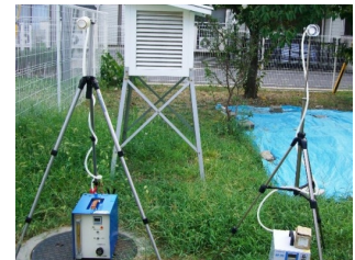
大気中の石綿濃度測定
