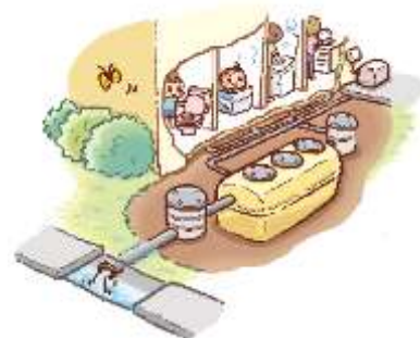
合併処理浄化槽設置イメージ
