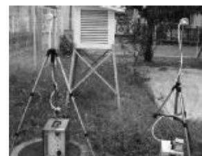
大気中の石綿濃度測定
