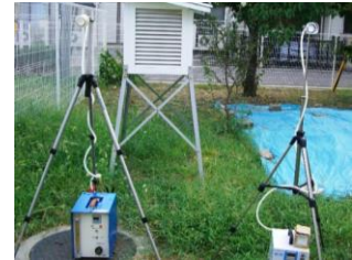
大気中の石綿濃度測定
