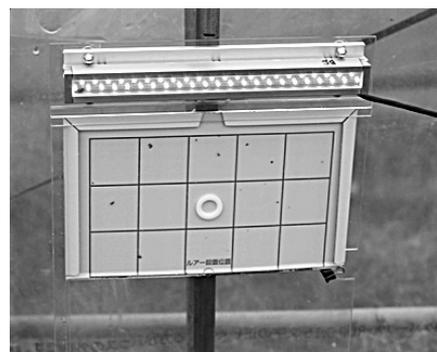
図 4-8 LED を用いた害虫の誘殺トラップ
