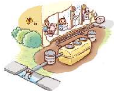
合併処理浄化槽設置イメージ
