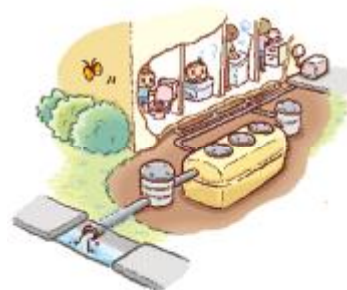
合併処理浄化槽設置イメージ
