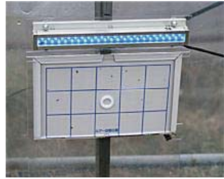
図4-8 LEDを用いた害虫の誘殺トラップ
