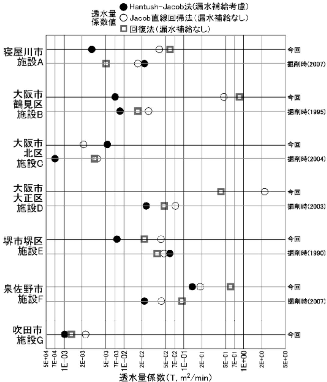
図 1 揚湯試験での透水量係数(T)の比較
