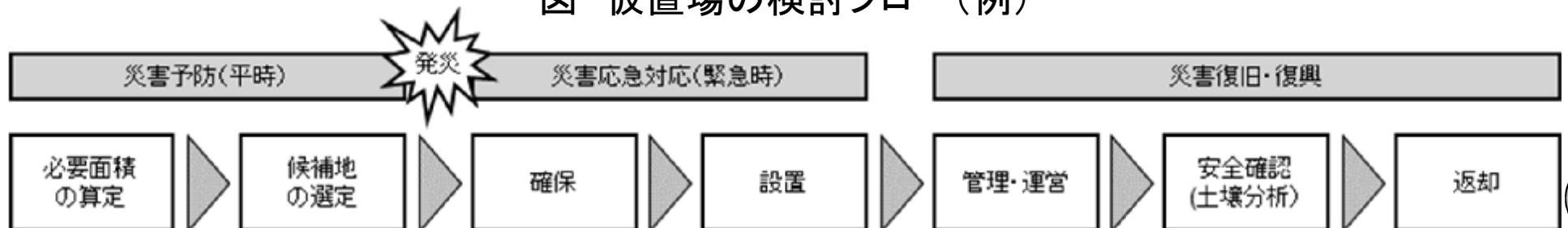
図 仮置場の検討フロー(例)
