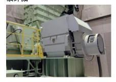
廃棄物に混入す るがれきやコン クリートがらな どを破砕処理し て、選別に適した 粒度に破砕
