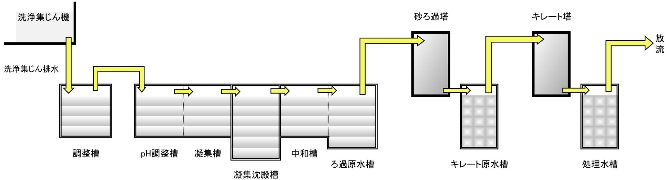
排水処理施設(洗浄集じん排水)の処理方式別
