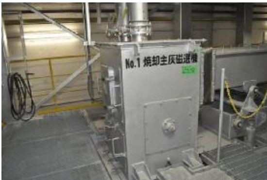
磁選機：主灰の中の金属を除去する
