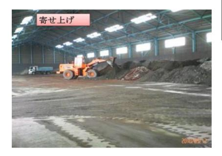
ストックヤード内では、廃棄物の積み下ろし、寄せ上げ、積み込みの作業が随時行われている。
