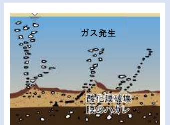
DOが低い場合、嫌気分解に伴い発生したガスにより、酸化膜が剥がれる
