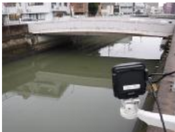
固定カメラによるスカム発生状況の監視
