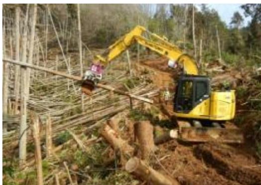
高性能林業機械を用いた倒木処理
