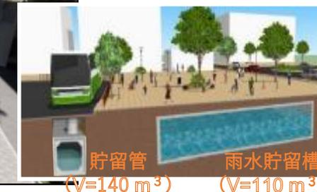
貯留管 (V=140 m<sup>3</sup>) 雨水貯留槽 (V=110 m<sup>3</sup>)
