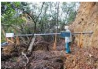
地盤伸縮計による地盤変動量の観測
