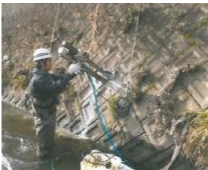
写真 4.3-1 コアボーリング、カメラによる空洞化調査
