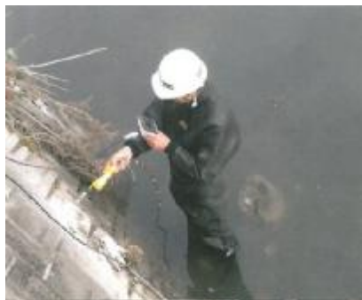
写真 4.3-1 コアボーリング、カメラによる空洞化調査
