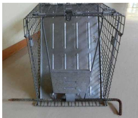
扉が開かないようにかんぬきを挿した例
