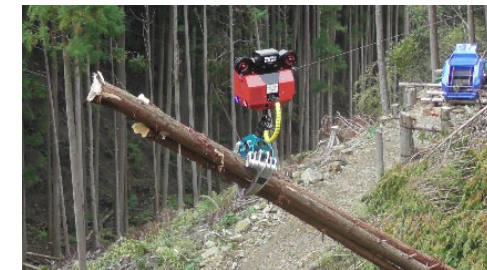
自動化機械を活用した 架線集材
