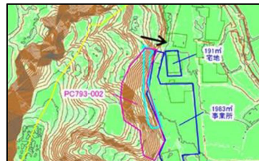
高精度な地形情報（航空レーザー測量）による抽出 ⇒傾斜度30度以上 ⇨ 調査の対象
