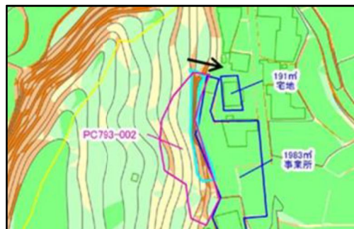
地形図判読（航空写真測量）による抽出 ⇒傾斜度30度未満 ⇨ 調査の対象外
