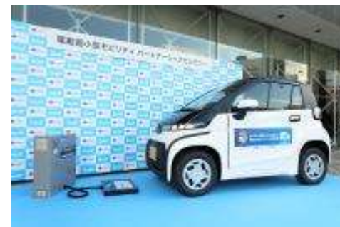
庁内カーシェア （ワイヤレス充電の電動超小型モビリティ）
