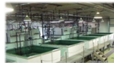
閉鎖循環式 陸上養殖システム (提供: 国立研究開発法人水産研究・教育機構)
