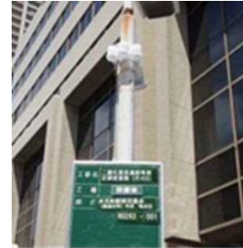
二酸化窒素濃度の簡易測定
