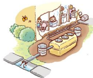
合併処理浄化槽設置イメージ
