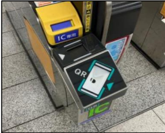
クレジットカードのタッチ決済、 QRコード対応された自動改札機 (写真提供：近畿日本鉄道株式会社)
