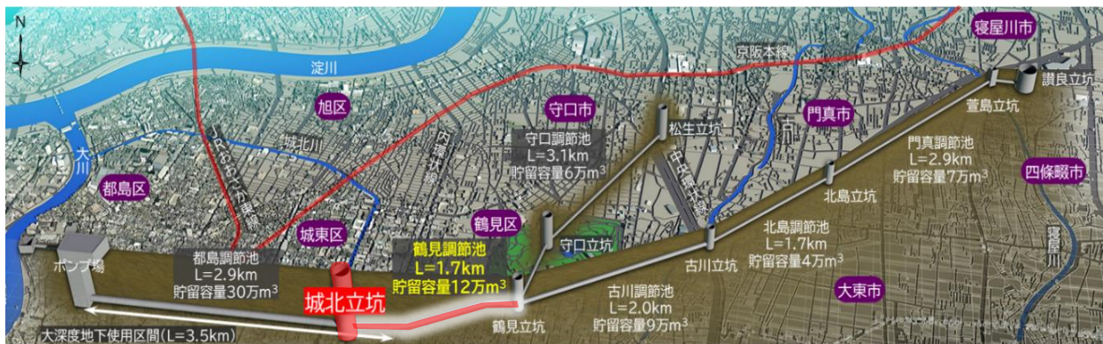
寝屋川北部地下河川断面イメージ図
