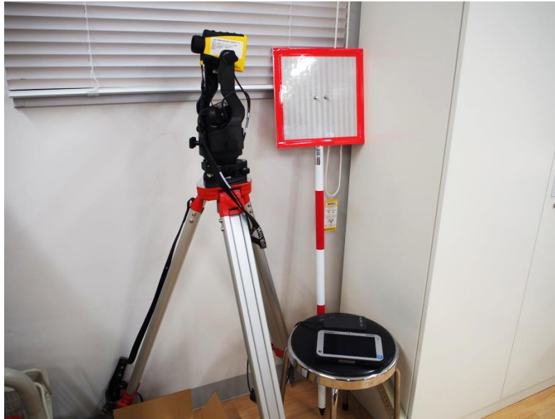
デジタルコンパスによる測量
