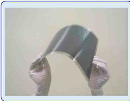
ビル壁面等への設置が可能となる太陽電池の技術例（出典：NEDO）
