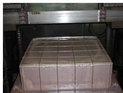
多結晶シリコンインゴットを 680 角材から 125 角柱 25 個取
