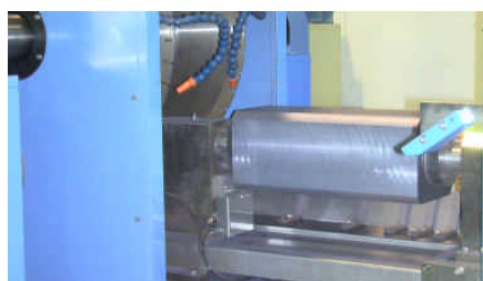
円柱から4面切断研磨及び4コーナー面取り済みのシリコン角柱
