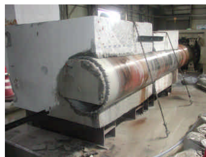
外径 600mm 長さ 5m を穿孔する マックスビットマシン
