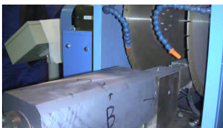
ダイヤモンドによる角柱切断完了
