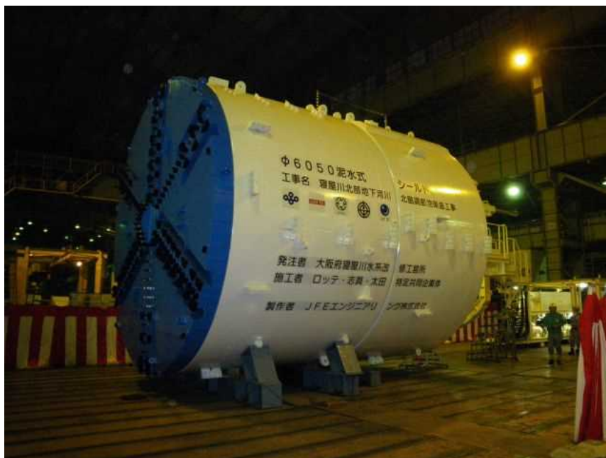
地下河川の施工に用いられたシールドマシン(掘削機)です。
