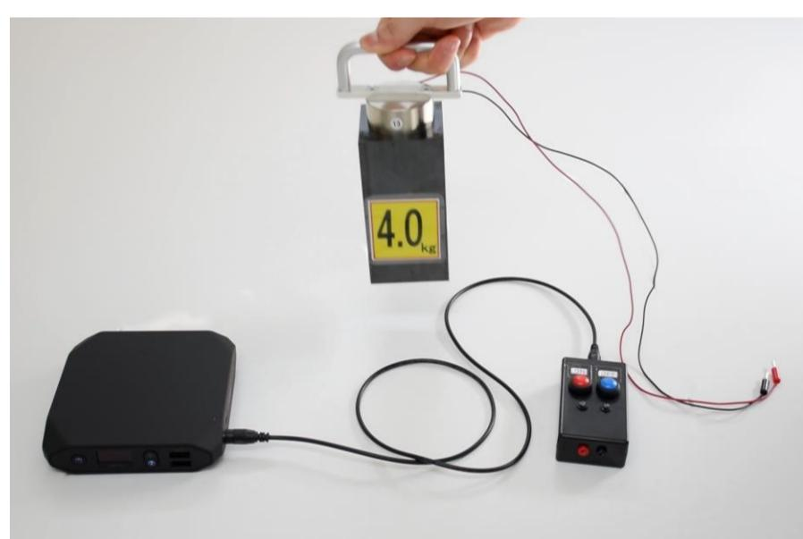
スイッチングマグホルダーは、一度吸着すると無通電で吸着し続けるので、吸着後は消費電力がゼロです。活用場所によっては、従来品と比べて消費電力を大きく削減することができ、二酸化炭素排出量の削減や人手不足解消にも貢献します。
