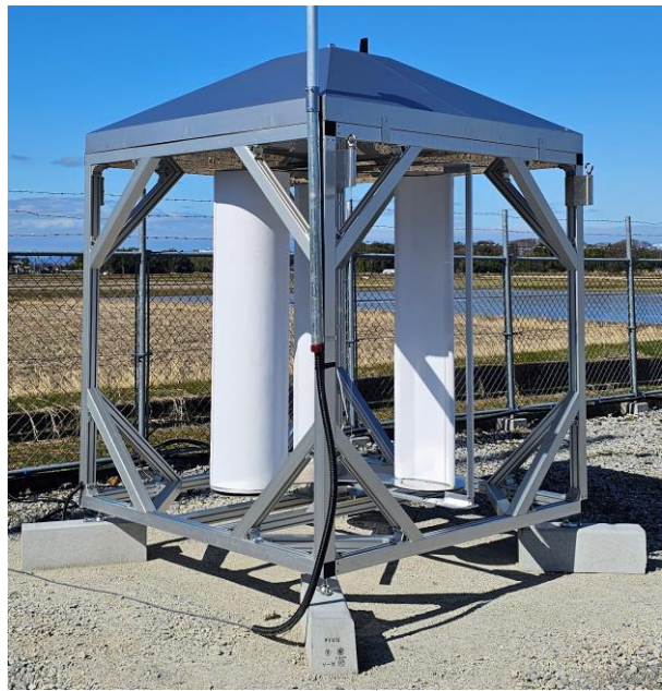
実証実験中の 勾玉形風力発電設備
