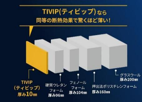
ステンレス密封真空断熱パネル (TIVIP [ティビップ] ) は、ステンレス箔を使用し、パネル内部を真空状態にすることで熱伝導を非常に低く抑えた高性能な断熱材です。
