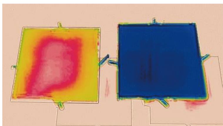
鉄板・日射反射塗料・SPACECOOL の裏面温度\*
