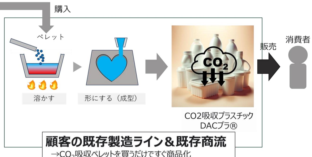
CO<sub>2</sub>吸収材を添加することで、CO<sub>2</sub>排出量を最大11%削減したCO<sub>2</sub>吸収プラスチックを開発。プラスチックの機械強度や意匠性に影響を与えることなく、誰もが環境貢献できる社会を目指しています。
