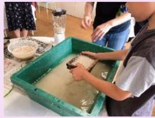
パルプ液の中に、網を挟んだ型枠を浸し、型枠を左右に軽く揺らながら、網の上のパルプ液を平らにします。次に、型枠を持ち上げてパルプ液から取り出します。
