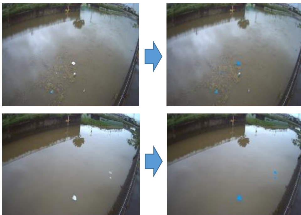
図4 元画像（左）とA Iによりごみと判別された部分を色付けした画像（右） （地点：恩智川上流（カメラ設置箇所：恩智川治水緑地））
