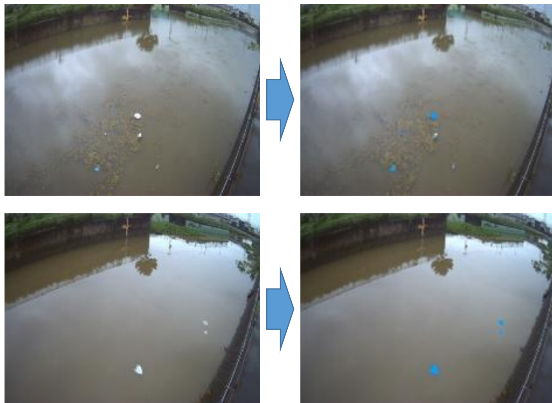
元画像（左）とAIによりごみと判別された部分を色付けした画像（右） （地点：恩智川中流（カメラ設置箇所：恩智川治水緑地））
