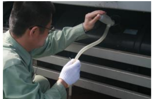
図4-1-1 軽油の抜き取り検査
