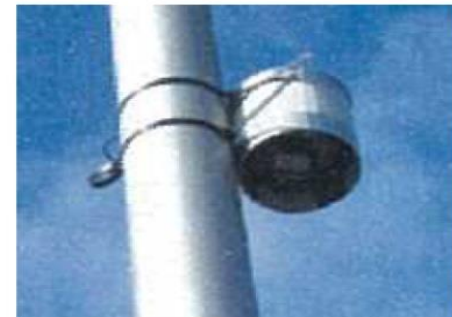
【簡易測定手法】 監視測定局よりも容易に 多くの地点に設置可能。
