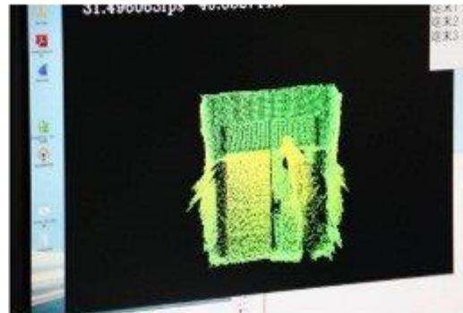
荷室の積載状況(左)がLiDARによってスキャンされ、3Dの点群データ(右)としてリアルタイムに確認できる
